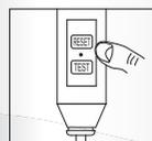
Le bouchon PRCD doit être testé avant chaque utilisation pour éviter tout risque de choc électrique. N'utilisez pas la pompe si ce test s'est soldé par un échec.
