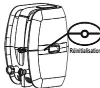
Si la température du tableau de commande (ou la température de l'eau) n'a pas changé 4 à 5 heures après l'activation du système de chauffage, utilisez un objet fin pour appuyer sur le BOUTON DE RÉINITIALISATION (RESET) et redémarrez le système de chauffage.
