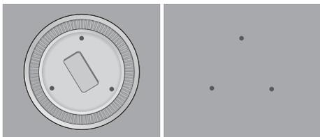
4. Utilisez un foret de 5 mm de diamètre et percez les positions repérées, le perçage doit avoir une profondeur de 3 cm. Nettoyez les trous après perçage.
