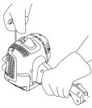
Dès que le moteur est mis en marche, laissez le levier du starter en position Half choke (intermédiaire) pendant 20 secondes. Amenez ensuite le levier du starter en position RUN (Marche).
