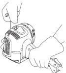
REMARQUE! Ne pas sortir complètement la corde du lanceur et ne pas lâcher la poignée avec la corde du lanceur complètement sortie. Cela pourrait endommager la machine.
