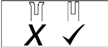
Remplacez le guide-chaîne quand la rainure est usée, quand le guide-chaîne est plié ou fissuré ou quand les rails atteignent des températures excessives ou sont ébréchés. Si un remplacement se révèle nécessaire, utilisez exclusivement le type de guide-chaîne spécifié dans la liste des pièces détachées de cette tronçonneuse ou sur l'autocollant situé sur la tronçonneuse.
