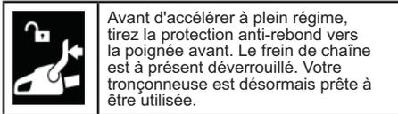
Avant d'accélérer à plein régime, tirez la protection anti-rebond vers la poignée avant. Le frein de chaîne est à présent déverrouillé. Votre tronçonneuse est désormais prête à être utilisée.
