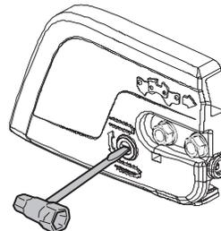
Tension de la chaîne - modèles à réglage avant :
