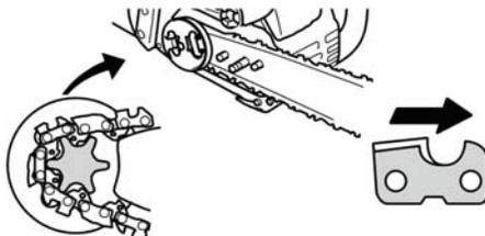
3. Assurez-vous que les maillons d'entraînement s'engagent dans le pignon d'entraînement et que la chaîne est correctement placée sur le guide-chaîne.
