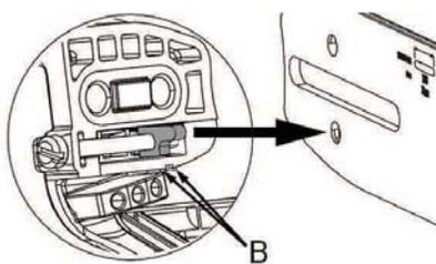
1. Tournez la vis de réglage à la main dans le sens contraire des aiguilles d'une montre jusqu'à ce que la goupille de réglage soit positionnée entre les repères (B) sur le carter de l'embrayage. Ceci doit permettre à la goupille de réglage d'être pratiquement dans la bonne position.
