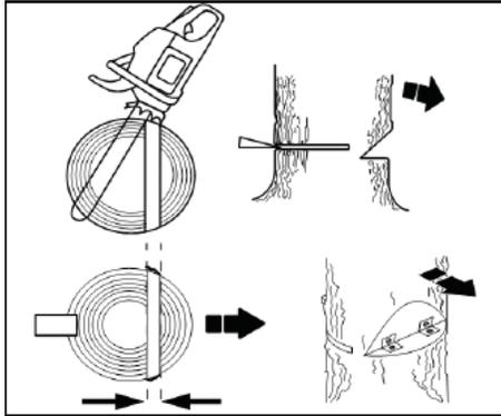
**REMARQUE :** avant que la coupe d'abattage soit achevée, utilisez des coins d'abattage pour ouvrir l'entaille, si nécessaire, afin de maîtriser la direction de la chute. Pour éviter un rebond et d'endommager la chaîne, utilisez des coins d'abattage en bois ou en plastique, mais jamais en acier ou en fer.
