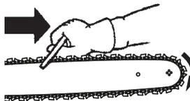
**REMARQUE** : la chaîne est correctement tendue lorsque son poids ne la fait pas fléchir au-dessous du guide-chaîne (la tronçonneuse en position verticale), et qu'elle se déplace librement autour du guide-chaîne.
