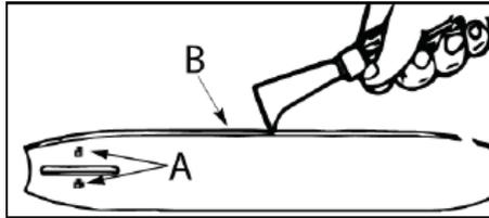
3. La formation de barbes sur les rails du guide-chaîne est un signe normal d'usure. Éliminez ces barbes à l'aide d'une lime plate.
