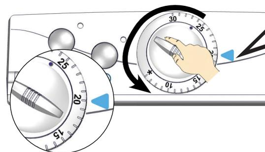
Bloquer le bouton de réglage de la température ⑥ et faites tourner la bague d'étalonnage ⑤ **uniquement** afin de positionner l'indication 20°C en face de la flèche repère de réglage ⑦.
