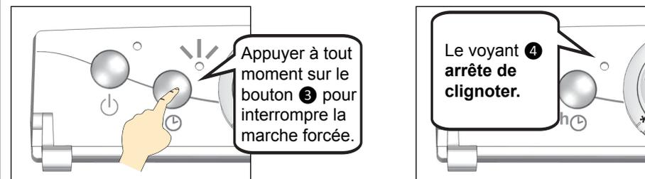
À la fin du cycle ou après l'interruption, l'appareil revient dans le mode de fonctionnement qui était le sien avant le démarrage de la marche forcée.
