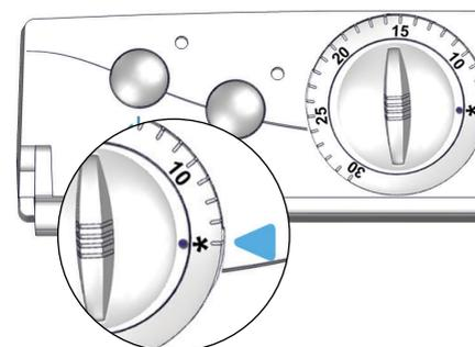
Faire coïncider le point en relief situé sur le bouton de réglage de la température ⑥ avec le symbole hors-gel de la bague d'étalonnage ⑦.
