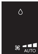
Ce mode est idéal pour réduire l'humidité dans la pièce (printemps et automne, pièces humides, périodes de pluie, etc.). Pour ce type d'utilisation, l'appareil doit être configuré comme pour le mode climatisation. C'est-à-dire que le tuyau d'évacuation d'air (B2) doit être installé sur l'appareil pour permettre l'évacuation de
