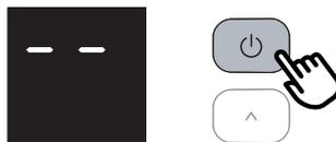
Effleurez la touche
