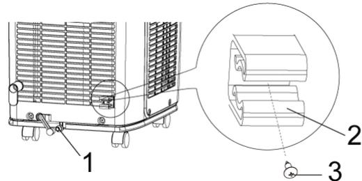
3. Insérer le tuyau de drainage (4) dans l'orifice de drainage et le visser puis le fixer avec le petit crochet (2). Insérer le bouchon à l'autre extrémité du tuyau de drainage (1), le fixer avec le petit crochet (2) puis l'insérer dans le collier (3).
