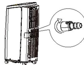
2. Visser le tuyau de raccordement fourni avec l'appareil en le tournant dans le sens des aiguilles d'une montre.
