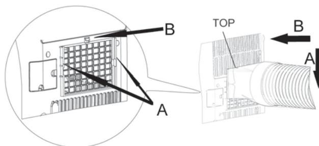
Raccorder à la partie finale du tuyau flexible le raccord circulaire pour fenêtre (1) puis le raccord terminal pour fenêtre (2).
