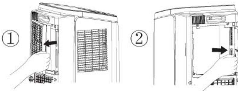
Le filtre à air doit être contrôlé au moins une fois toutes les deux semaines de fonctionnement. Le fonctionnement de l'appareil avec des filtres sales ou obstrués entraîne inévitablement une diminution de l'efficacité du climatiseur et peut provoquer de sérieux dommages.
