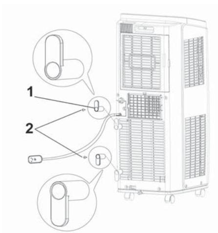
Les crochets doivent être orientés l'un vers le haut et l'autre vers le bas.
