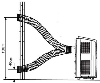
Pendant les périodes de non-utilisation, débrancher le tuyau et fermer le hublot avec le bouchon.
