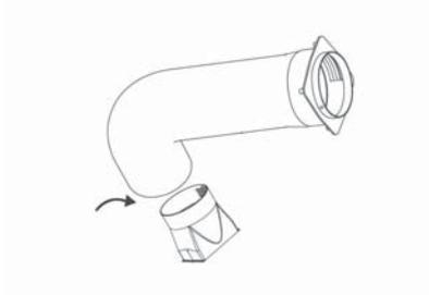
Insérer le hublot dépourvu de bouchon de fermeture dans la fenêtre. Insérer le raccord circulaire pour kit hublot dans le tuyau flexible et insérer le tuyau flexible rétractable avec le raccord circulaire dans le hublot.
