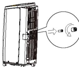
1. Retirer le capuchon en le tournant dans le sens inverse des aiguilles d'une montre puis retirer le bouchon.
