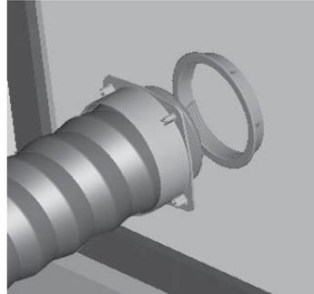
Insérer le tuyau flexible ainsi monté à l'arrière du climatiseur.
