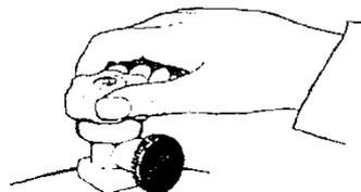
b) S'assurer qu'il y ait le joint d'étanchéité à l'intérieur de l'écrou de serrage sur le régulateur de pression. Ce joint doit être remplacé chaque fois que vous changez la bouteille de gaz.
