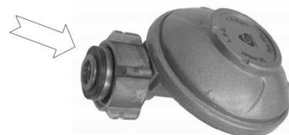
c) Visser et serrer à fond le régulateur à la vanne de la bouteille en tournant dans le sens antihoraire avec la clé correcte. Serrer fort pour une bonne fermeture. Si l'écrou est moleté serrer à la main. Attention pour visser, tourner dans le sens contraire des aiguilles d'une montre. Après le vissage de l'écrou sur la valve de la bouteille, le régulateur ne doit pas être mis en rotation afin d'éviter d'abimer le joint dans la zone du joint.
