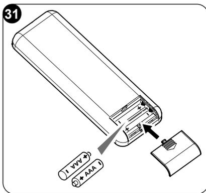
La télécommande utilise deux piles alcalines sèches de 1,5 V (type AAA.LR03) (fig. 31). Après avoir remplacé les piles, réglez l'horloge de la télécommande.
