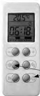
1) Pour programmer ou modifier l'horaire, appuyez sur le bouton "Stand-by" puis sur le bouton "Mode" et maintenez-les enfoncés jusqu'au clignotement du chiffre indiquant le jour.
