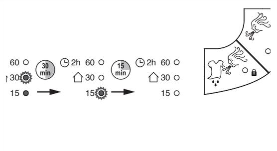
Pour terminer le programme SOUFFLERIE avant la fin de la durée indiquée, il faudra appuyer sur la touche DRYER. En cas de coupure de courant pour un laps de temps inférieur à 5 s, le programme SOUFFLERIE reprendra à fonctionner de manière autonome. Si la coupure dépasse 5 s, le programme SOUFFLERIE sera interrompu.
