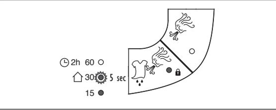
Les LEDs relatives à la durée commencent le compte à rebours pour indiquer le temps restant. La LED SOUFFLERIE est rouge fixe jusqu'à ce que le dispositif est en train de chauffer. La LED ON/OFF est violet si la résistance n'est pas active et rouge si la résistance est active.
