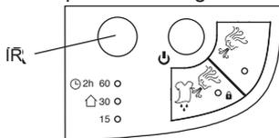
Pour obtenir une bonne réception du signal de la part du ventilateur, rester dans un rayon de 3 mètres de l'appareil, comme montré dans la figure.
