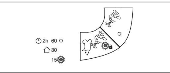
Dans un délai de 5 s il sera possible de modifier la durée en appuyant brièvement sur la touche SOUFFLERIE. La durée configurée s'affiche au moyen de la LED verte clignotante. Il est possible de configurer 15 min-30min-60min.
