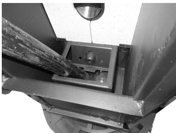
Fig. 22 - Nettoyage l'espace du brasero
