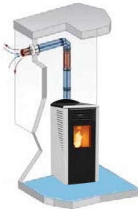
Exemples d'installation d'un poêle/poêle à granulés
