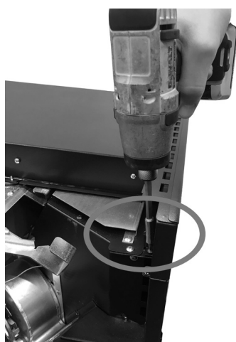
Fig. 61 - Fixation avant du tiroir
