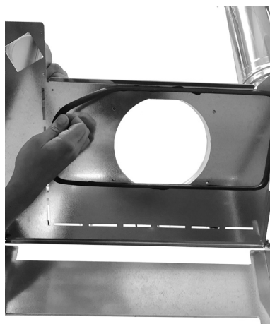
Fig. 58 - Retrait du joint d'étanchéité
