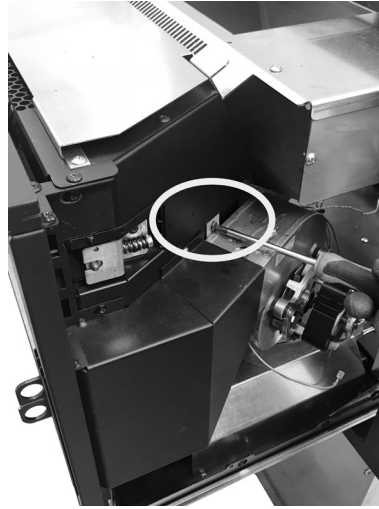
Fig. 101 - Retirer la vis 1
