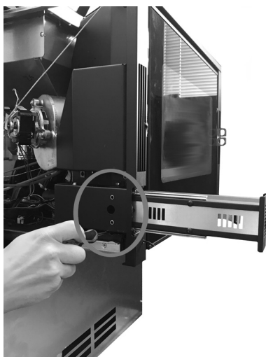
Fig. 89 - Fixer les vis
