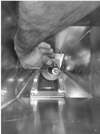
Fig. 98 - Retrait des spirales
