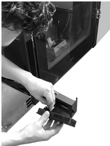
Fig. 86 - Retirer le câble plat
