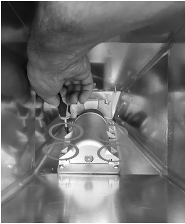
Fig. 95 - Retrait des vis
