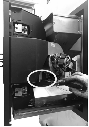
Fig. 102 - Retirer la vis 2
