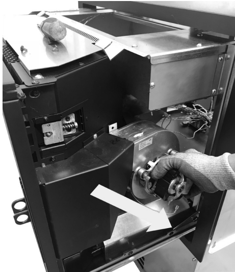
Fig. 103 - Retirer le ventilateur
