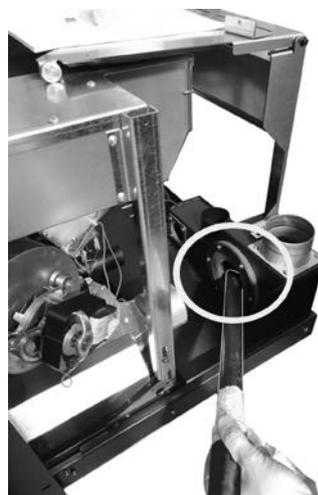
*Fig. 46 - Nettoyage du conduit d'évacuation des fumées*
