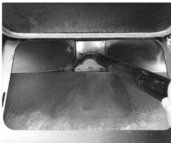
**Fig. 39 - Nettoyage réservoir et vis sans fin**
