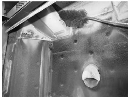
*Fig. 44 - Nettoyage avec un goupillon*
