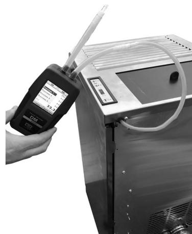
Fig. 26 - Connexion du pressostat numérique
