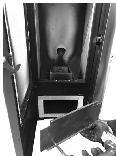
Fig. 31 - Retirer le bouchon d'inspection
