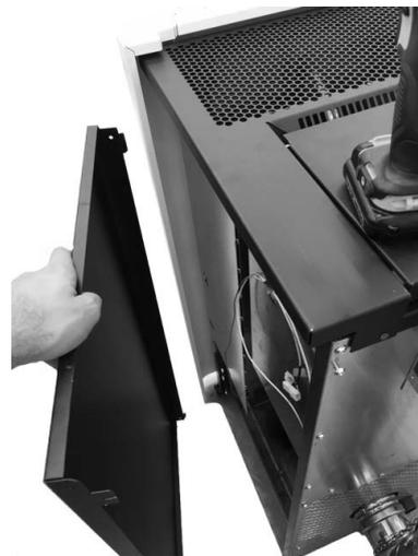
Fig. 22 - Dépose des côtés
