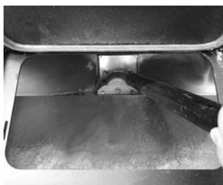
*Fig. 35 - Nettoyage réservoir et vis sans fin*
