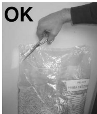
Fig. 20 - Ouverture correcte du sac des granulés
