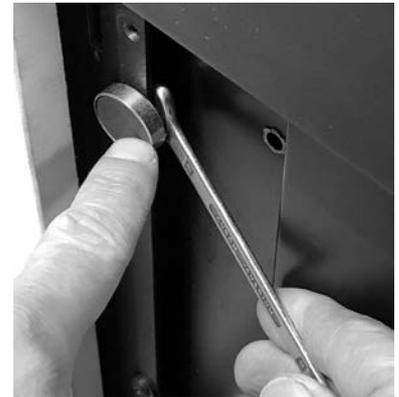
Fig. 43 - Régler l'aimant et bloquer avec la clé
