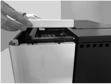
Fig. 41 - Mise en place du couvercle
