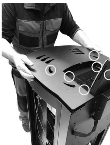
**Fig. 53 - Dépose du couvercle**
