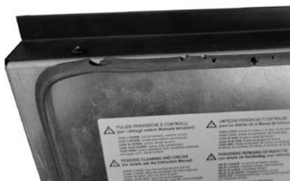
Fig. 21 - joint détérioré
