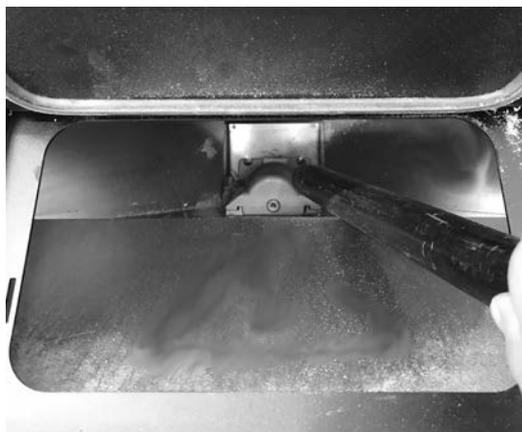
Fig. 27 - Nettoyage réservoir
