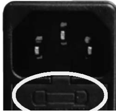
Fig. 75 - Hublot avec les fusibles à enlever
