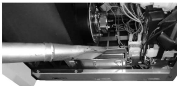
Fig. 88 - Nettoyage de le ventilateur ambiant (Mithos<sup>3</sup> Plus 12/14)
