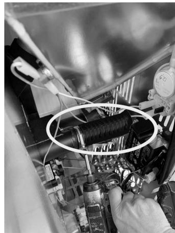
**Fig. 60 - Raccorder le tuyau flexible**
