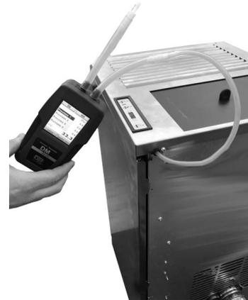
Fig. 79 - Connexion du pressostat numérique
