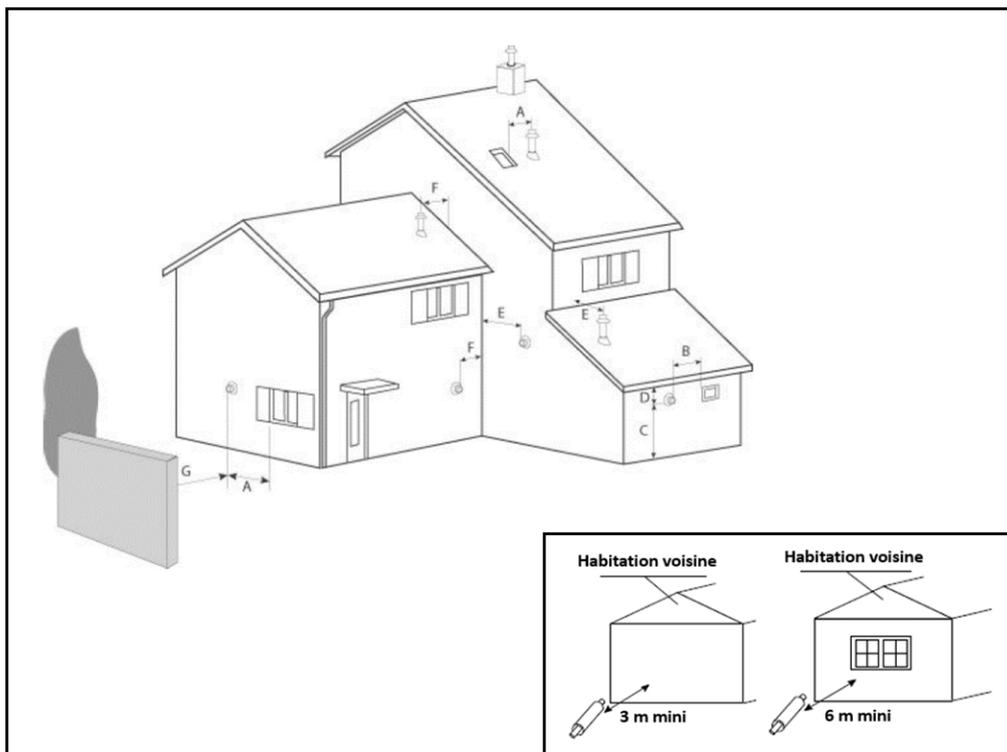
Fig. 16 - Position des terminaux
