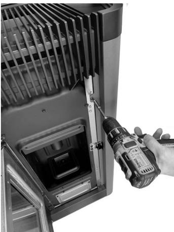
*Fig. 37 - Retirer les vis antérieures*
