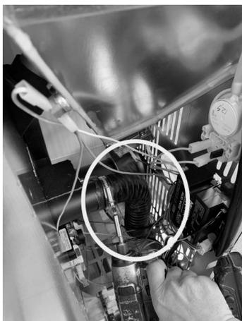
**Fig. 52 - Retirer le tuyau flexible**
