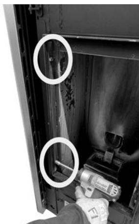
*Fig. 105 - Ôter les vis hexagonales*
