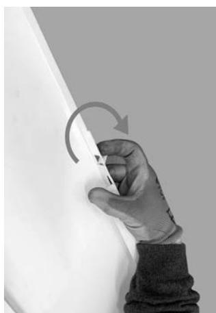
**Fig. 51 - Plier les languettes**
