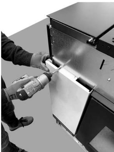
*Fig. 45 - Fixer les panneaux latéraux*
