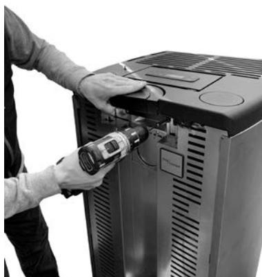
Fig. 58 - Retirer le bouchon (Atena<sup>3</sup> Plus 12/14 - Duke At)
