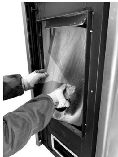
**Fig. 109 - Retirer le panneau arrière du foyer**
