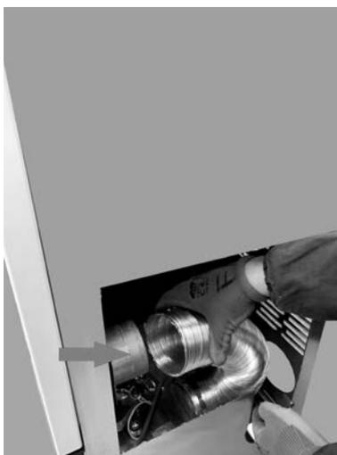
Fig. 80 - Détacher le tuyau flexible
