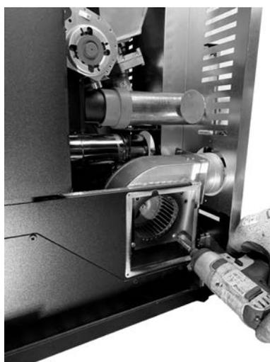
*Fig. 71 - Fixation du tuyau*
