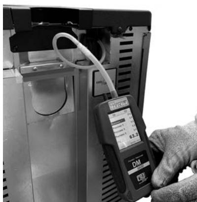
**Fig. 97 -** Connexion du pressostat numérique (Atena<sup>3</sup> Plus12/14 - Duke 12/14 At - Saba 12/14)
