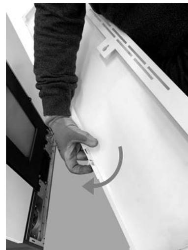
*Fig. 47 - Plier les languettes*
