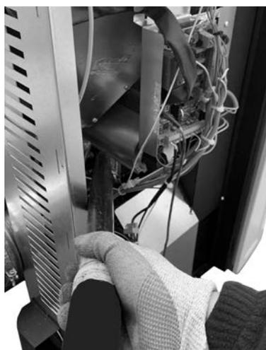
*Fig. 116 - Nettoyage de le ventilateur ambiant (Atena<sup>3</sup> Plus 12/14 - Duke 12/14 At - Saba 12/14)*
