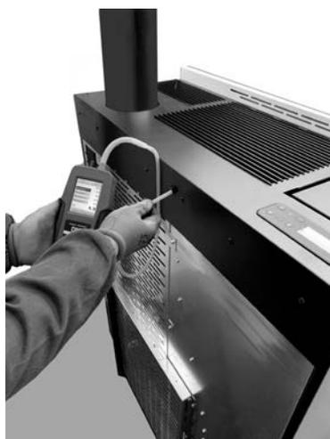
Fig. 98 - Connexion du pressostat numérique (Mithos<sup>3</sup> Plus12/14)
