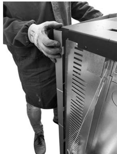
**Fig. 36 - Décrocher le flanc**
