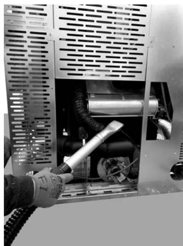
*Fig. 117 - Nettoyage de le ventilateur ambiant (Mithos<sup>3</sup> Plus 12/14)*
