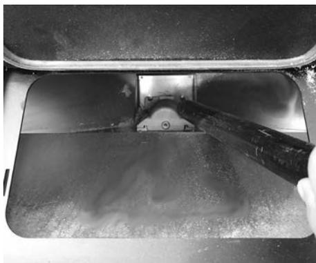
Fig. 31 - Nettoyage réservoir
