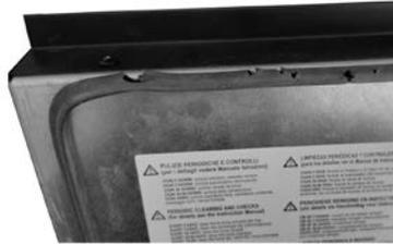
Fig. 23 - joint détérioré
