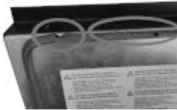
Fig. 27 - joint détérioré
