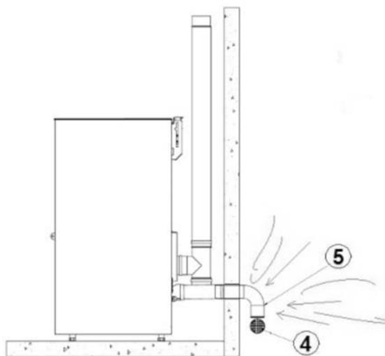
Fig. 9 - Prise d'air pour installation en chambre étanche
