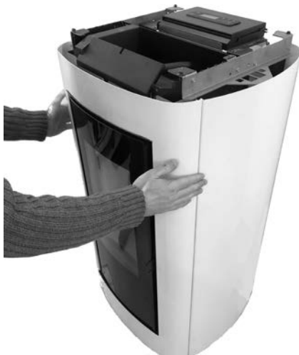
Fig. 60 - Décrocher le cadre
