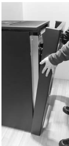
Fig. 34 - Retirer le cadre
