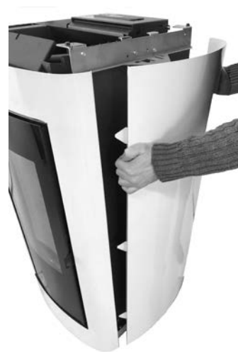
Fig. 57 - Retirer le flanc
