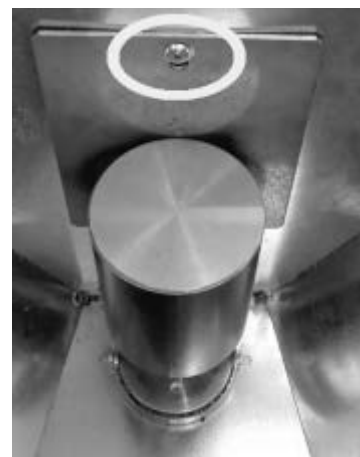
Fig. 111 - Retrait des vis
