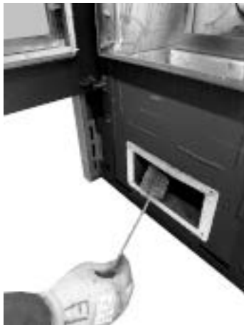
Fig. 93 - Nettoyer avec un goupillon
