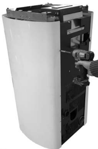
Fig. 56 - Retirer les vis postérieures
