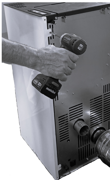
Fig. 22 - Retirer les vis
