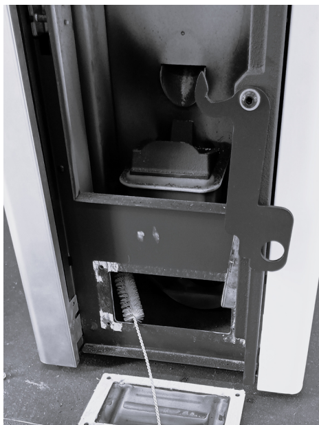
Fig. 37 - Nettoyer avec un goupillon.
