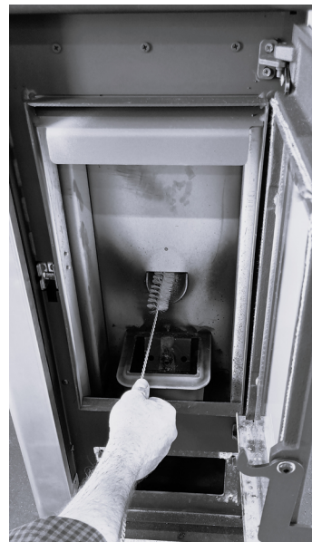
Fig. 40 - Nettoyage avec nettoie-pipes
