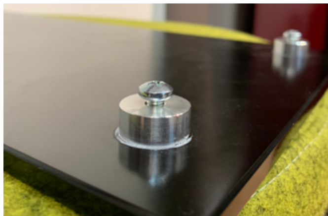
Fig. 53 - La vis doit dépasser
