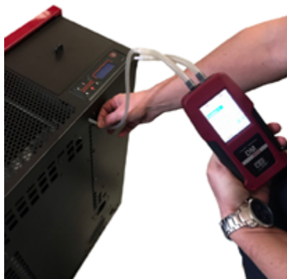
Fig. 95 - Raccordement du pressostat numérique
