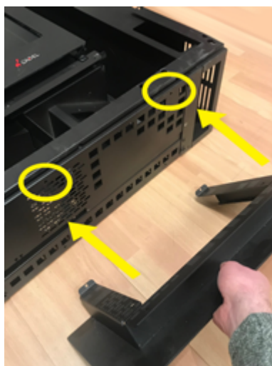
Fig. 82 - Mettre le piédestal en place
