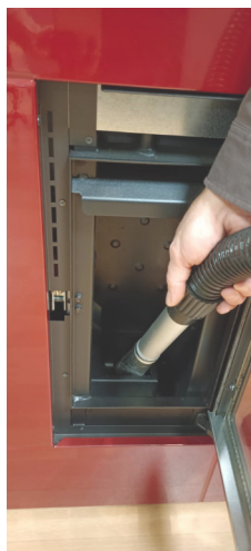
Fig. 44 - Nettoyage l'espace du brasero
