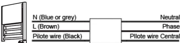
Configurazione in cui non viene utilizzato il filo pilota
