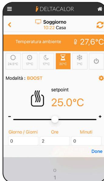
Quand le mode est activé, le thermostat affiche alternativement la température ambiante mesurée et le temps restant. Une fois le temps écoulé, le thermostat se remet sur le dernier mode utilisé.
