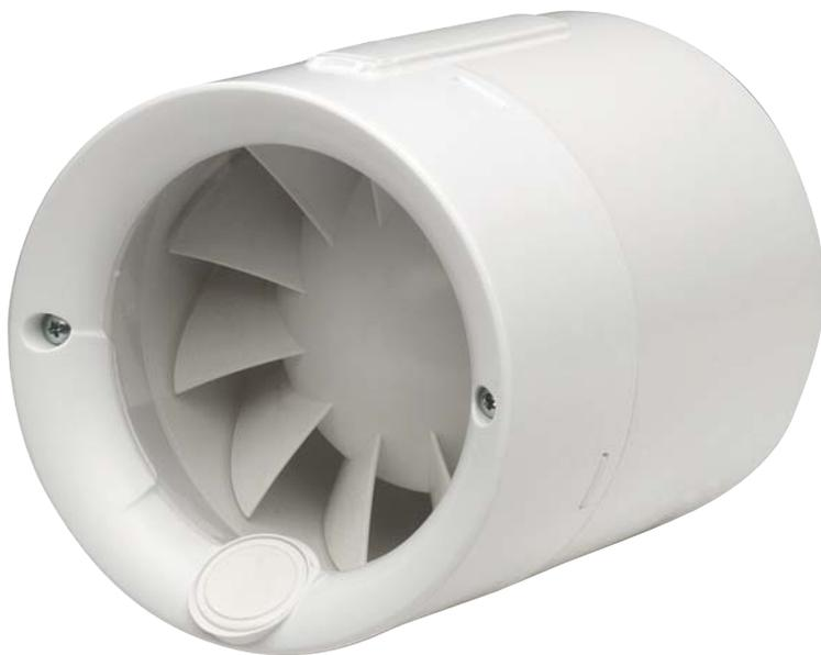
Extracteurs axial de conduit de très faible niveau sonore. Corps et hélice en polypropylène injecté. Clapet anti-retour. 2 passages de câbles possibles d'alimentation pour une installation plus facile. Température maxi de l'air ambiant: 40°C.
