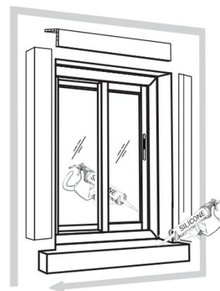
Pour une meilleure finition, utilisez des ailes de finition. Appliquez également un joint de silicone pour combler les écarts entre le dormant et la maçonnerie, ainsi qu'au niveau des ailes de finition.
