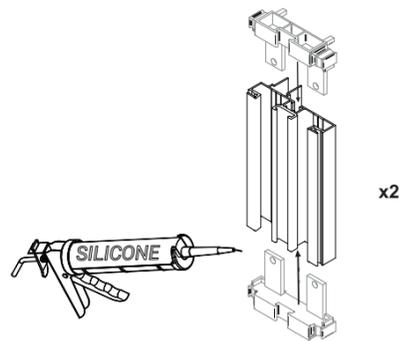
Avant de placer les embouts d'union, sceller le pourtour des extrémités des dormants latéraux avec du silicone neutre. Puis, insérez les 4 embouts d'union dans les dormants latéraux ( x 2 ) selon le dessin, et laisser la silicone agir.
