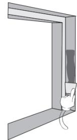
Si besoin, rectifier l'aplomb (vertical) et le niveau (horizontal) parfait.
