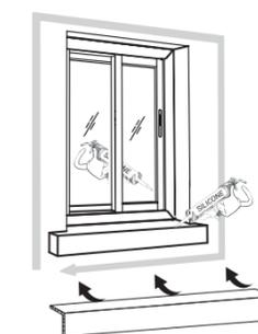
Dans tous les cas, les écarts entre le dormant et la maçonnerie doivent être comblés à l'aide de silicone, appliquer en profondeur pour une bonne étanchéité et permettre une dilatation lors des variations de températures. Pensez également à appliquer le silicone entre les ailes de recouvrement et le cadre de la fenêtre, côté intérieur et extérieur.
