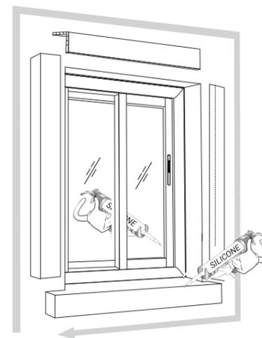
Pour une meilleure finition, utilisez des ailes de finition. Appliquez également un joint de silicone pour combler les écarts entre le dormant et la maçonnerie, ainsi qu'au niveau des ailes de finition.
