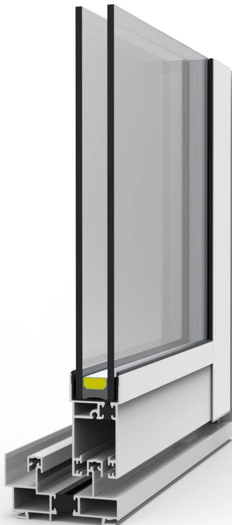
Menuiserie coulissante en aluminium à coupe des encadrements droit, épaisseur de cadre 65 mm, avec double système de rupture de pont thermique de résine d'haute densité dans les dormants et les ouvrants. Ouvrant central avec poignée carrée incorporée. Encadrements portant des ailes pour clipser les profils accessoires qui accompagnent à cette série : tapées d'isolations, ailes de recouvrement, élargisseurs, ou champlats.
