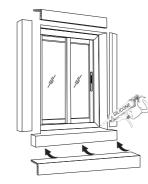
Utiliser les ailes de recouvrement, vendues séparémment, afin de recouvrir l'ancien cadre en bois. A utiliser à l'intérieur comme à l'extérieur, par simple système de clipsage. Des champlats peuvent aussi être utilisé pour une finition optimale.
