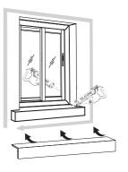
Dans tous les cas, les écarts entre le dormant et la maçonnerie doivent être comblés à l'aide de silicone, appliquer en profondeur pour une bonne étanchéité et permettre une dilatation lors des variations de températures. Pensez également à appliquer la silicone entre les ailes de recouvrement et le cadre de la fenêtre, côté intérieur et extérieur.
