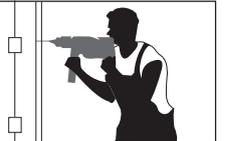
Perçer les trous pour les chevilles. Disposer des petites cales dans les jointures entre l'encadrement de porte et la maçonnerie dans la zone des points de fixation.
