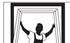
Disposer l'encadrement de la porte (attention au sens d'ouverture de la maçonnerie).
