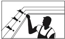
Repérer les emplacements pour les percages de cheville, à une distance minimale d'au moins 15 cm du coin et un écart max de 50 cm entre chaque percage.
