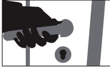
Vérifier le fonctionnement (ouverture et fermeture de la porte) réajuster si nécessaire les portes (celles-ci étant préréglées préalablement), le réglage final devant être effectué lors du montage.
