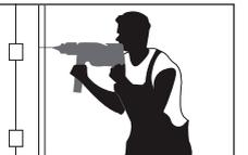
Perçer les trous pour les chevilles. Disposer des petites cales dans les jointures entre l'encadrement de porte et la maçonnerie dans la zone des points de fixation.
