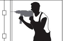
Percer les trous pour les chevilles. Disposer des petites cales dans les jointures entre l'encadrement de porte et la maçonnerie dans la zone des points de fixation.
