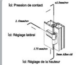
En cas de problème pour fermer la porte, veuillez ajuster en utilisant ce schéma
