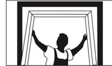
Disposer l'encadrement de la porte (attention au sens d'ouverture de la maçonnerie.
