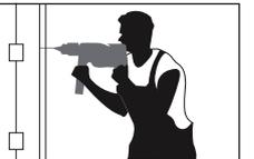
Percer les trous pour les chevilles. Disposer des petites cales dans les jointures entre l'encadrement de porte et la maçonnerie dans la zone des points de fixation.
