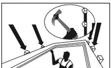
Fixer les côtés droit et gauche de l'encadrement avec 3 cales chacune. Attention, aucune contrainte en torsion ou en pression ne doit s'exercer sur l'encadrement !
