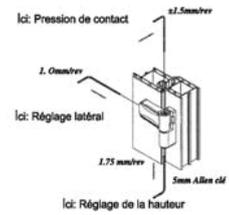
En cas de problème pour fermer la porte, veuillez ajuster en utilisant ce schéma
