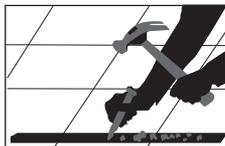
Réaliser les opérations initiales requises (entaille sur le sol si celui-ci est uni, etc...)
