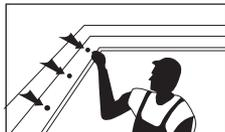
Repérer les emplacements pour les perçages de cheville, à une distance minimale d'au moins 15 cm du coin et un écart max de 50 cm entre chaque perçage.
