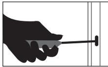
Accrocher le battant, aligner l'encadrement de porte côté serrure avec le battant (le battant devant s'ajuster complètement sur l'encadrement) Et fixer l'encadrement côté serrure à l'aide des chevilles.
