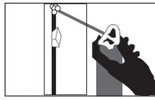
Remplir les jointures entre l'encadrement de porte et la maçonnerie avec un cordon d'étanchéité ou de la mousse isolante.
