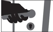
Vérifier le fonctionnement (ouverture et fermeture de la porte) réajuster si nécessaire les portes (celles-ci étant pré-réglées préalablement), le réglage final devant être effectué lors du montage.
