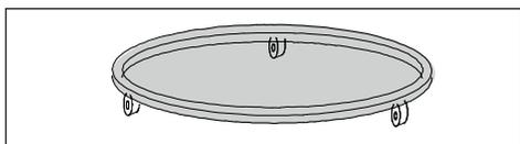
Assurez-vous que le support à roulettes soit placé en-dessous du plateau en verre. Ne placez aucun autre plateau en dehors du plateau en verre sur le support à roulettes. Lavez le support à roulettes avec de l'eau chaude et savonneuse au moins une fois par semaine.
