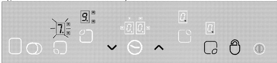
"0" cette touche vous permet de verrouiller/déverrouiller la commande tactile en mode de fonctionnement.
