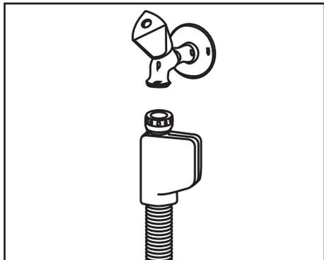
**⚠** Comme l'ensemble du tuyau contient des branchements et éléments électriques, vous ne devez ni raccourcir ni allonger le tuyau avec des rallonges.
