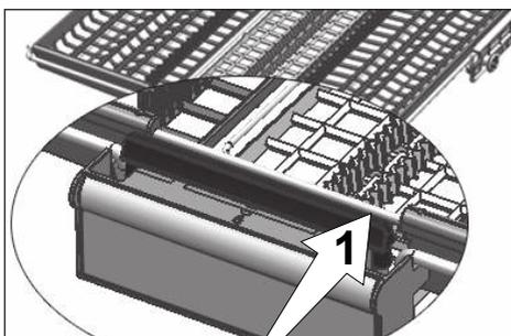
Dans les modèles avec fonction de mouvement partiel, lorsque vous poussez la barre (1) sur la poignée, le plateau central du panier passe à la position inférieure et le système se déverrouille. Ainsi, les plateaux à droite et à gauche peuvent être utilisés comme pièces mobiles.
