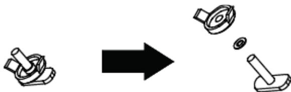
2. Séparez les 2 pièces de la barre à glissière et insérez la vis dans le trou.
