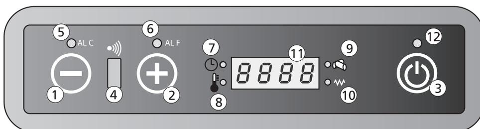
Touche 1 : Baisse la température ambiante souhaitée par l'utilisateur. Touche 1 peut également être utilisé pour afficher et modifier l'état du rendement calorifique.
