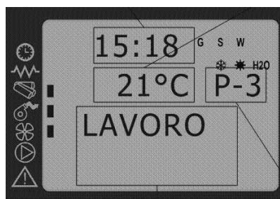
La fase de modulación se alcanza si la temperatura ambiente alcanza el valor fijado en "TEMPERATURE SET (CONFIGURAR TEMPERATURA)". Durante esta fase, el cargador de pellets, el ventilador del extractor de humo y el del intercambiador de calor se reducen a velocidad mínima, y aparecerá en el display el mensaje "OPERATION MODE" (MODO USO).
