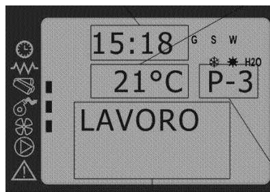
La fase di modulazione avviene se la temperatura ambiente raggiunge il valore impostato in "SET TEMPERATURA". Durante questa fase la coclea e la ventola di estrazione dei fumi e dello scambiatore vengono portati alla velocità minima, e sul display apparirà la scritta "LAVORO MODULA".
