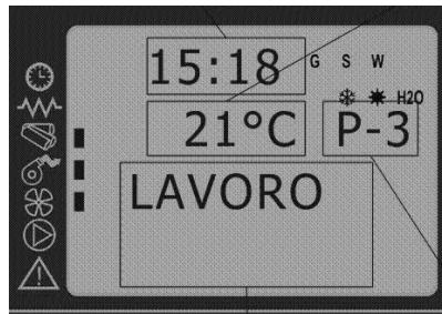
De modulatiefase vindt plaats als de kamertemperatuur de waarde die ingesteld werd in "INSTELTEMPERATUUR" bereikt. Tijdens deze fase gaan de pelletlader en zowel de rookgasafzuigventilator en de warmtewisselingsventilator naar hun minimumsnelheid en zal het bericht "BEDRIJFSMODUS" op het scherm weergegeven worden.
