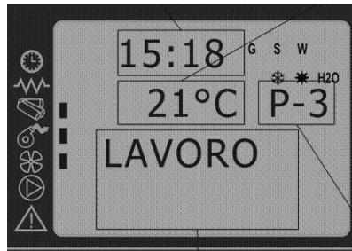
La phase de modulation a lieu lorsque la température ambiante atteint la valeur configurée dans "TEMPERATURE SET »(TEMPÉRATURE CONFIG.). Au cours de cette phase, le chargeur de granulés et le ventilateur d'extracteur de fumée ainsi que le ventilateur d'échange de chaleur sont réduits à leur vitesse minimale, et le message apparaît sur l'écran «OPERATION MODE » (MODE DE FONCTIONNEMENT).
